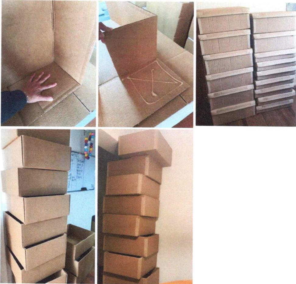
2. Proceso de armado de bases con unión de lados y refuerzos de papel engomado en uniones, esquinas y bordes.
