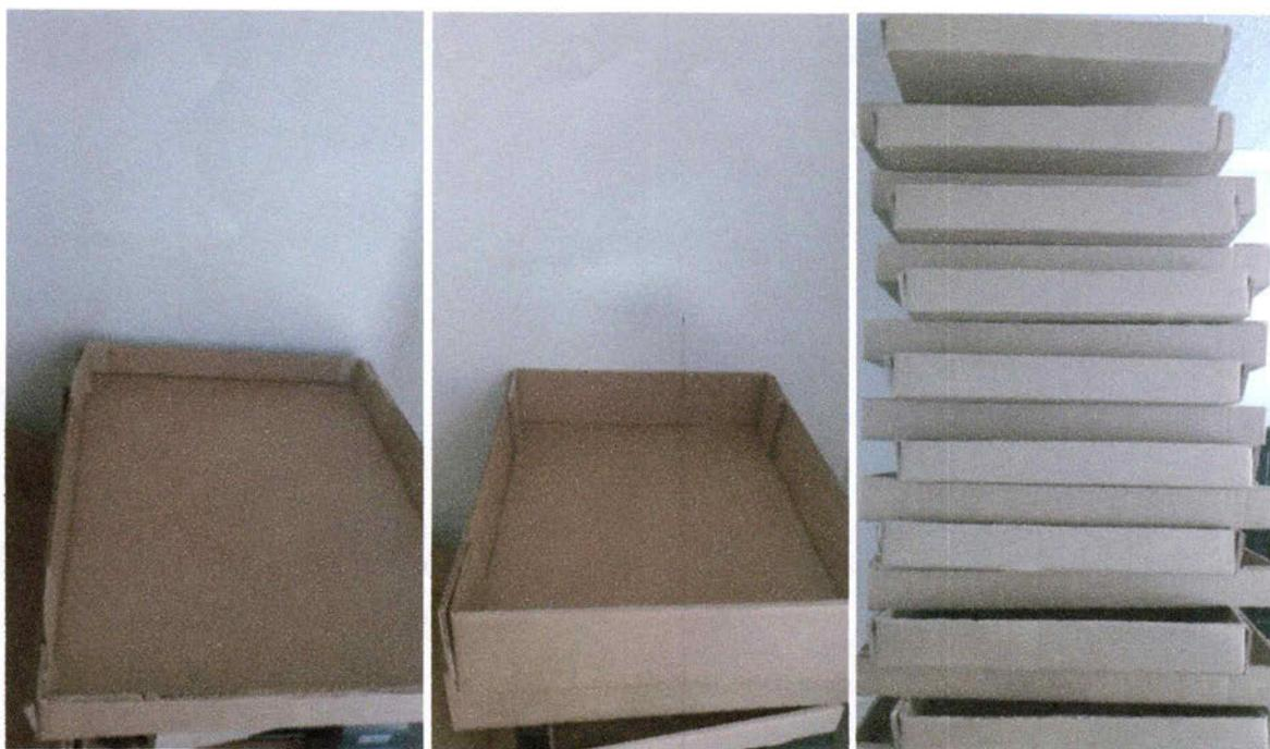
2. Proceso de armado de bases con unión de lados y refuerzos de papel engomado en uniones, esquinas y bordes.
