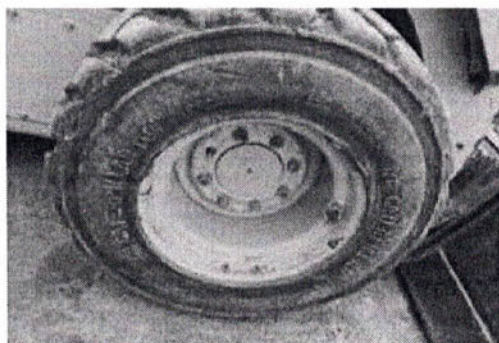
Apoyo y recepción de neumático arreglado para minicargador
