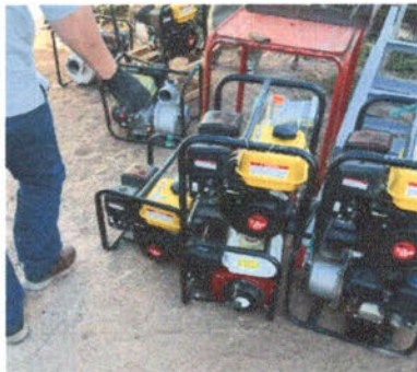
Apoyo e inspección para mantenimiento motobombas plan invierno
