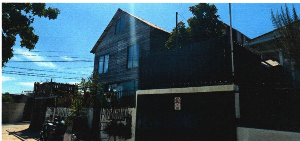
**Imagen actual de la edificación evidencia un segundo piso de madera en sector posterior, el cual esta construido sobre la vivienda original.**
